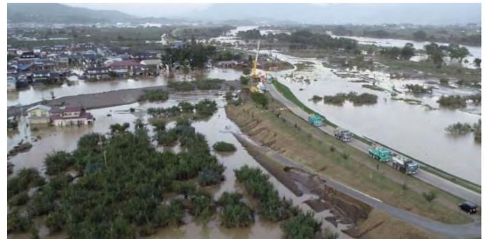
長野市で発生した千曲川の破堤に伴う被災状況。UAV（ドローン）で国土地理院が撮影。
